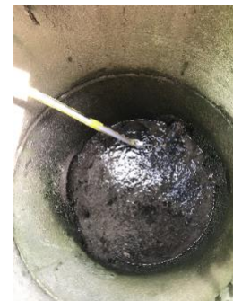
Abb.: Messproben aus dem Sediment aus Sammelschächten geben Hinweis auf mögliche PSM-Einträge in Gewässer.
