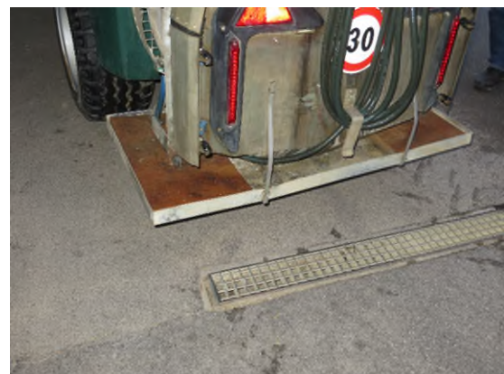
Abb.: Mithilfe der Auffangwanne werden Tropfen vom Sprizenturm aufgefangen und deren Eintrag in Gewässer verhindert.
