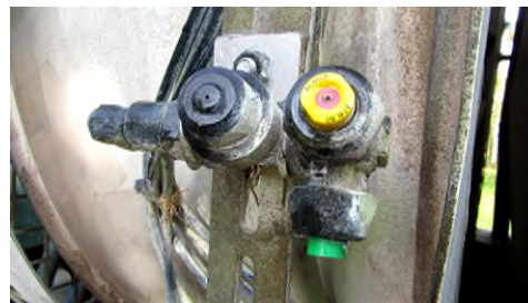
Abb.: Eine an die Kultur angepasste Düseneinstellung vermindert das Eintragsrisiko von PSM in ein Gewässer und verbessert den Kulturschutz.
