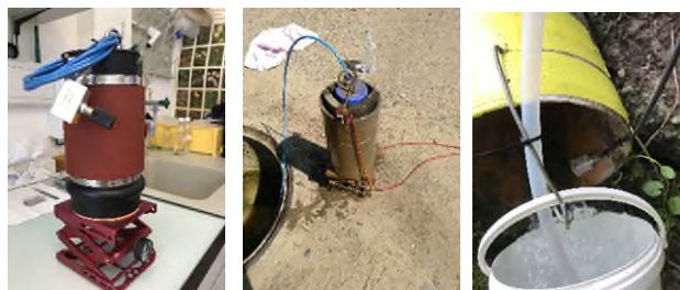
Abb.: Links: Passivsampler vor Inbetriebnahme. Mitte: Passivsampler nach Inbetriebnahme; Rechts: Aktivsampler in einer Drainage.
