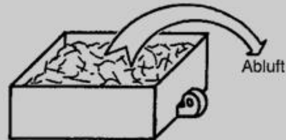
Abluft vom Stock wird vom Lüfter angesaugt
