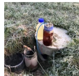
Abb.: Fixe Messstelle in einem Drainageschacht.
