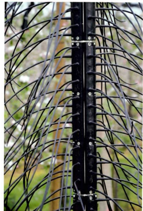
Bild 23: Spindel mit Schnurleisten. Bei Bedarf kann eine ganze Ebene abgeschraubt werden...
