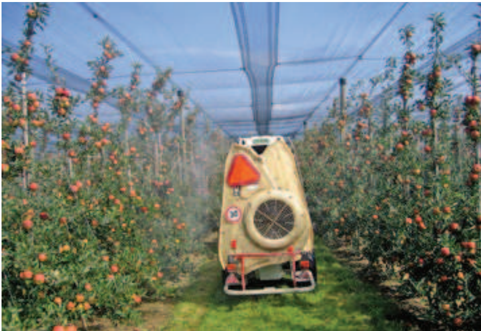
Applikation links mit Standarddüsen, rechts mit Injektordüsen. (zVg)
