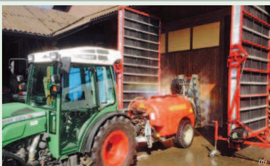
Obstbauspritze auf dem Lamellenprüfstand des SVLT – dieses Jahr findet der obligatorische Spritzentest in der Region Sulgen vom 19. bis 29. März statt.
