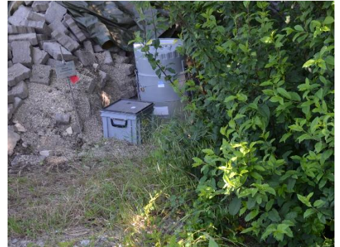
Messstelle im Rahmen des Projektes; Bei Niederschlagsereignissen werden mit Hilfe des Gerätes Wasserproben aus dem angrenzenden Bach entnommen. (Bild: AfU)
